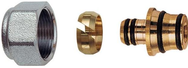
Концовка для металлопластиковой трубы. Подходит ко всем изделиям, снабженным гайкой с резьбой M24x19.
